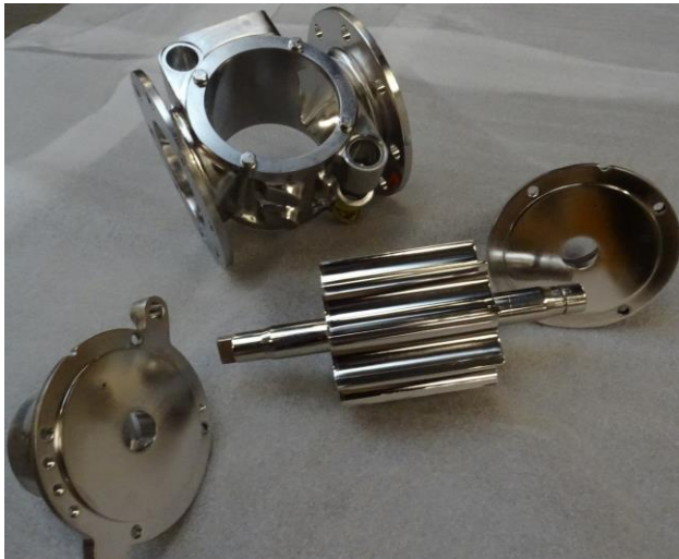
Roterende doseersluis, gereviseerd en elektrolytisch gepolijst
