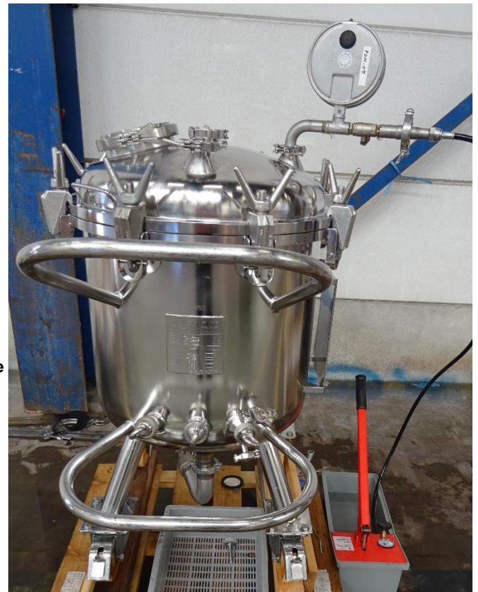
Farma, revisie farma reactor middels mechanisch en electropolijsten
