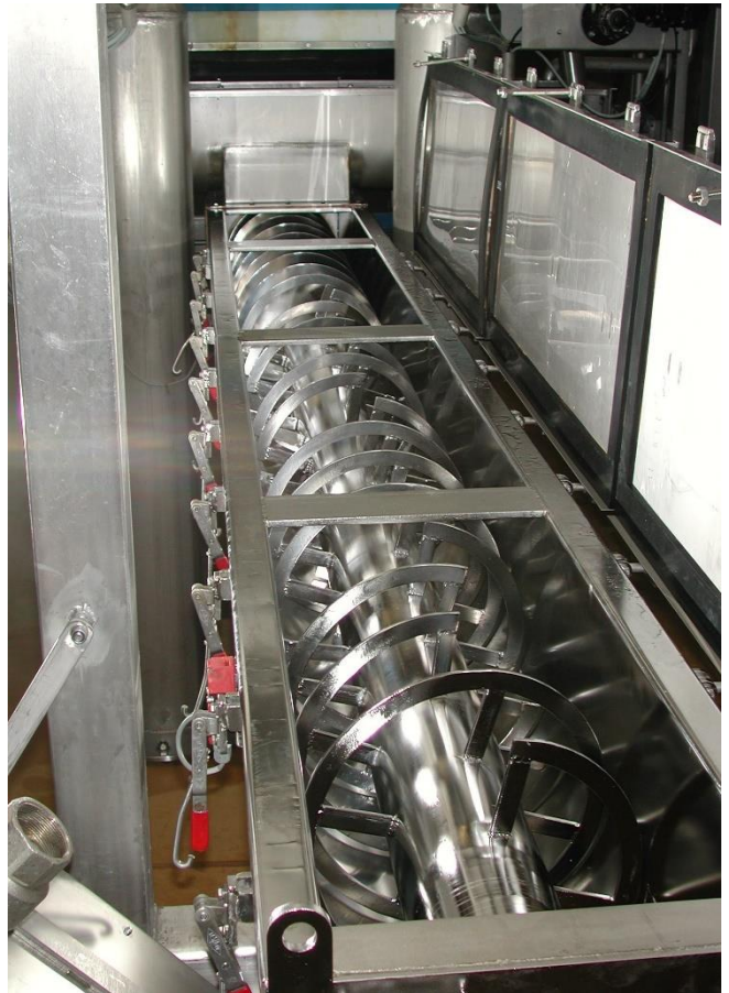
Zetmeel, Archimedesschroef met anti-kleef amorfiseren, na drie jaar in gebruik
