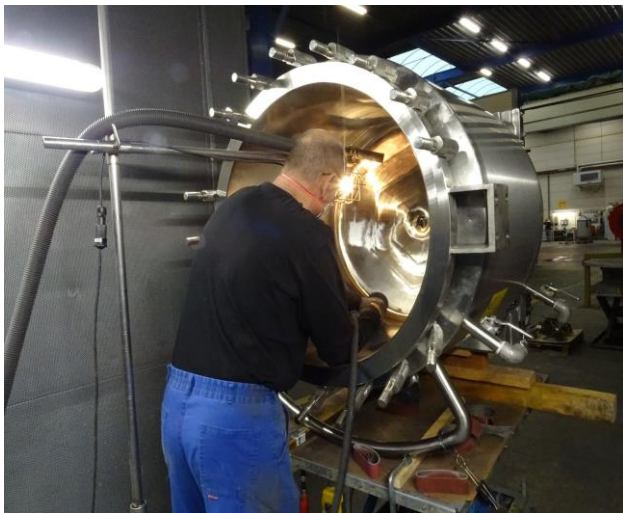
Farma, mechanisch polijsten van farmareactor met schade
