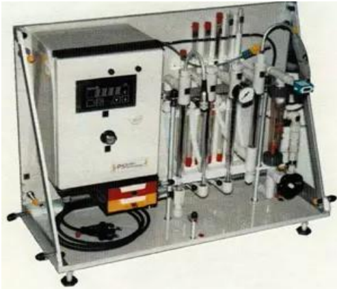
Afbeelding 5 Multiple Monitoring Systeem van PS-Biofilm. Een combinatie van probes voor biofilm monitoring, corrosie monitoring en sealing monitoring. De probes bevinden zich in glazen buizen (rvs buizen voor hoge-druktoepassing) waardoor het water stroomt volgens een instelbaar laminair stromingspatroon. Het meest toegepaste industriële veldmeetsysteem voor koelwater en andere watertypen. Afbeelding 1 toont een biofilm op een probe-segment uit dit systeem. De biofilm wordt visueel en of electrachemisch gemonitord. Bij electrachemische monitoring wordt een beginnende biofilm al binnen enkele uren gedetecteerd. Foto: www.corrosie.nl .
