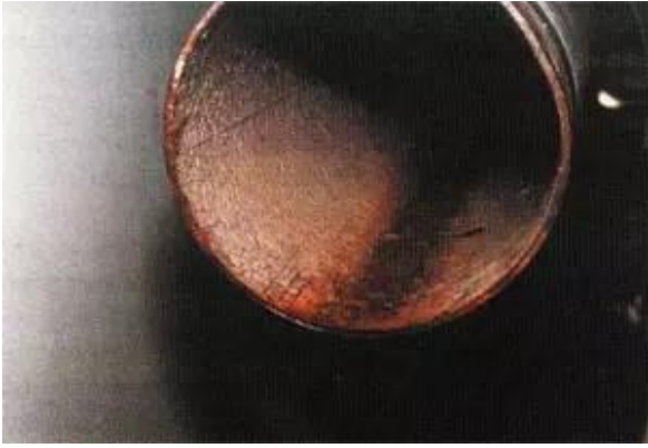
Afbeelding 2 Sulfaatreducerende bacteriën houdende biofilm in een roestvaststalen waterleiding. Foto: www.corrosie.nl
