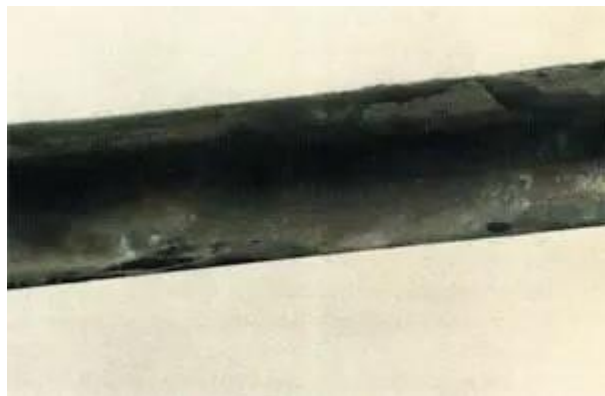
Afbeelding 1 Biofilmvorming binnen drie dagen op roestvaststalen probeselement van het PS-Biofilm monitoring systeem (zie afbeelding 5). Diameter probe: 8 mm.
