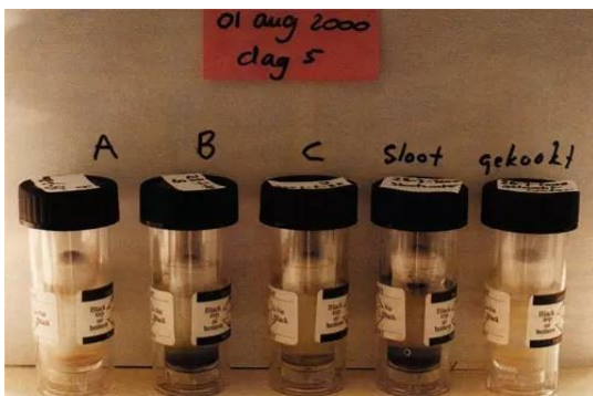
Afbeelding 8 'Instant' test voor het kwantitatief aantonen van sulfaatreducerende bacteriën in water. Het aantal dagen dat het duurt totdat de bodem of de onderkant van het witte balletje zwart wordt, bepaalt de hoeveelheid srbs. <2 dagen: zeer agressief, >8 dagen: niet agressief. Foto: www.corrosie.nl
