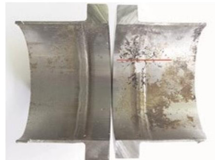
▲ Figuur 3: Macroscopisch beeld van gefaalde zone (zijde aangezuurd product / CIP). De rode lijn duidt de positie aan van metallografisch onderzoek.
