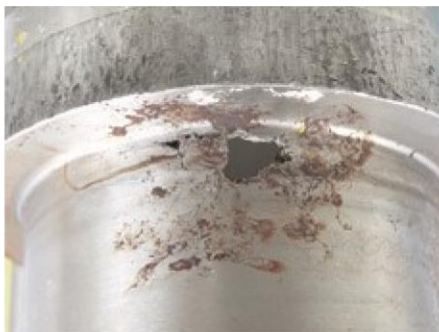
▲ Figuur 2: Macroscopisch beeld van gefaalde zone (zijde stoom)
