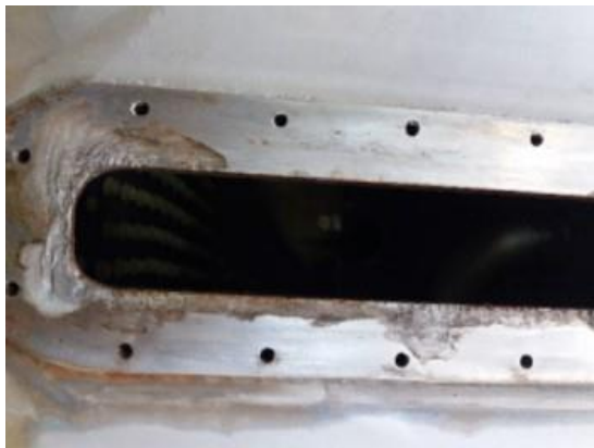
Afbeelding 1: spleetcorrosie onder de pakking van roestvast staal.
