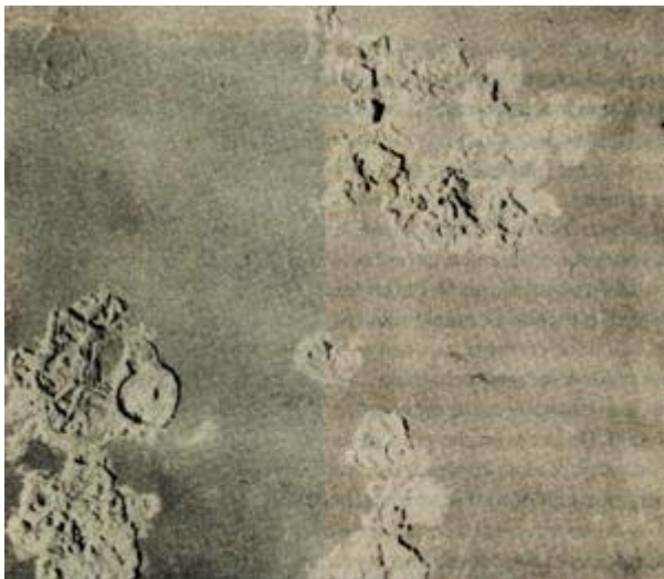
Afb. 1. Spleetcorrosie onder mosselaangroei op rvs AISI304.
