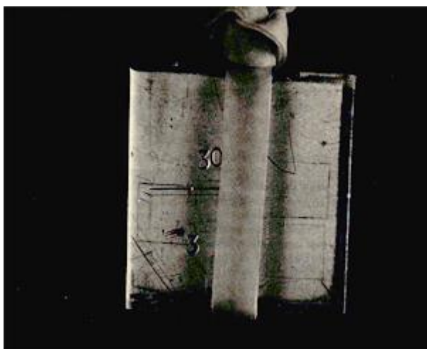
Afb. 2. Proefpleetje (rvs AISI 304), voorzien van elastiekje, voor onderdompeling in testoplossing (3% NaCl + 10% Fe 2 (SO 4 ) 3 in water).
