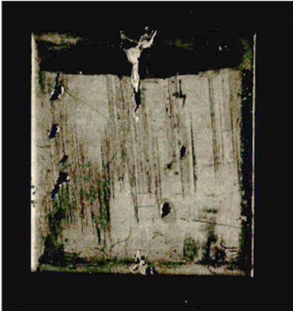
Afb. 3b. Zelfde-proefplaatje als foto 3a, andere zijde; hier treedt sterke spleetcorrosie en putvormige corrosie op. Deze zijde wordt gekenmerkt door veel mechanische oppervlaktebeschadigingen.
