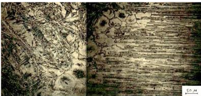
Afb. 1: Las, warmtebeïnvloede zone en beïnvloed basismetaal van duplex rvs.
