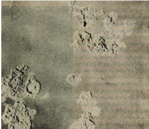
Afb. 1. Spleetcorrosie onder mosselaangroei op rvs AISI304.
