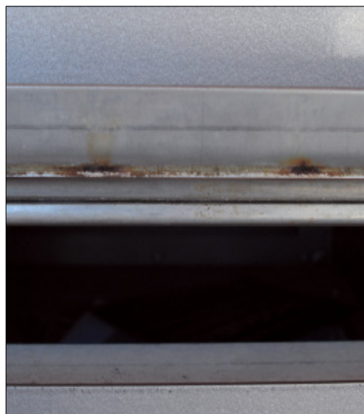
Voor brievenbussen wordt vaak kwaliteit AISI 304 gekozen, wat onvoldoende is wanneer men niet de juiste passivatie toepast
