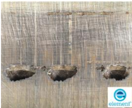
Figuur 1. Putcorrosie en knife line attack langs de beide smeltlijnen van een las (twee rijen van putten) in de wand (316Ti) van een scheepsijsmachine (medium zeewater). De las en het plaatmateriaal bleken bestand tegen het gekoelde zeewater, de warmtebeïnvloede zones echter niet.
