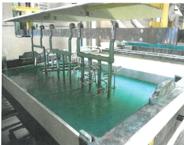
De te behandelen onderdelen worden opgehangen aan een elektrisch geleidende drager of rek en ondergedompeld in een chemisch bad
