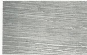
Oppervlak na mechanisch polijsten
