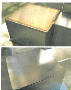
Gelast onderstel voor en na polijsten
