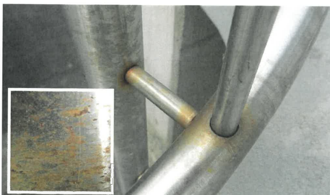
Het roesten treedt des te sneller op waar de chroomoxidehuid beschadigd is
