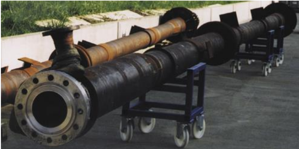
Reactoren voor de polymeerchemie, inwendig elektrolytisch gepolijst voor hoge weerstand tegen aankleven. (Packo Surface Treatment www.electropolish.be )
