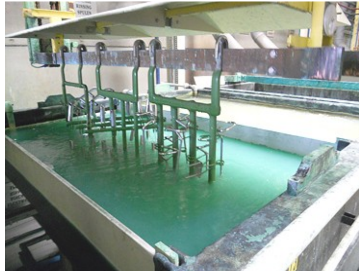
De te behandelen onderdelen worden opgehangen aan een elektrisch geleidende drager of rek en ondergedompeld in een chemisch bad
