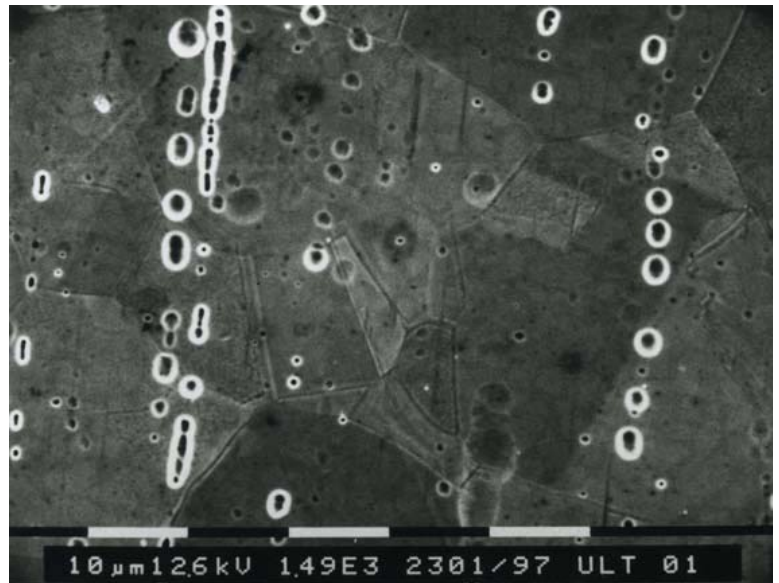
Afbeelding 2: Elektrolytisch gepolijst roestvast staal 316L oppervlak dat geen kanaalvorming meer toont op de korrelgrenzen. V = 1500x . (Foto: Dockweiler Nederland)
