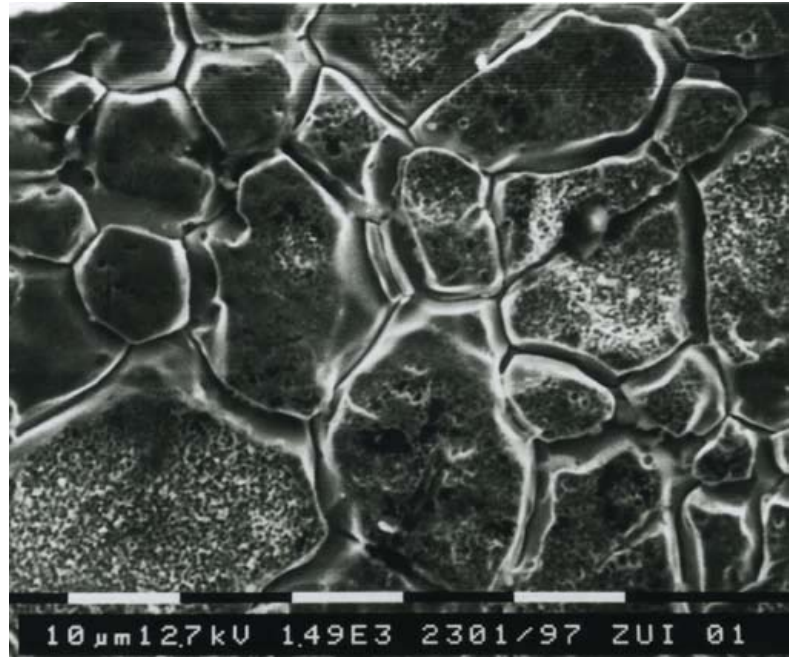
Afbeelding 1: Microscopische opname van een gebeitst roestvast staal AISI 316L oppervlak. Duidelijk is de 'kanaalvorming' te zien op de korrelgrenzen. V = 1500x. (Foto: Dockweiler Nederland)
