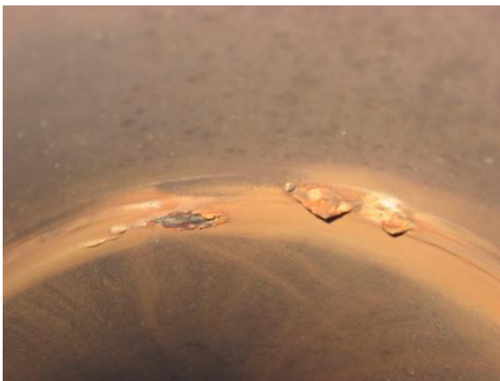
Foto: MIC op en naast een duplex rvs las. MIC manifesteert zich in de vorm van 'hoedjes', zogenaamde tubercles, op de putcorrosie t.g.v. MIC. Onder de hoedjes kan de zuurgraad dalen tot pH-2 of nog lager.
