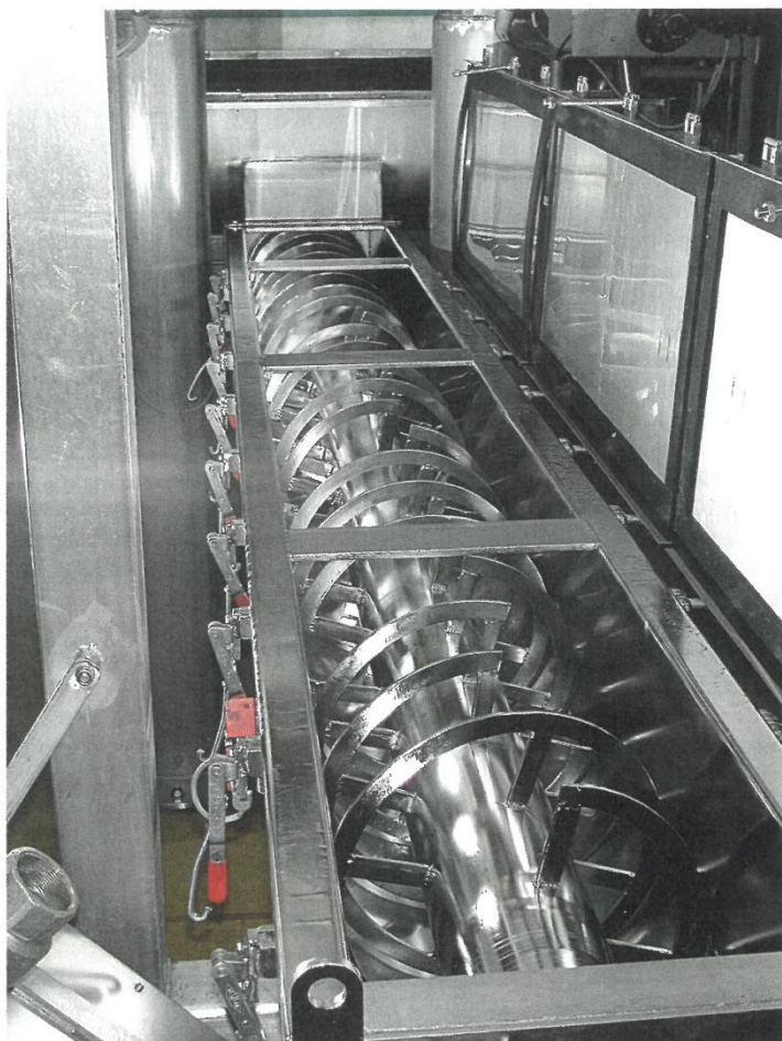
Figuur1 - tegen aan kleven van zetmeel: Amorfiseren zorgt voor een lagere wrijvingsweerstand en een betere reinigbaarheid.
